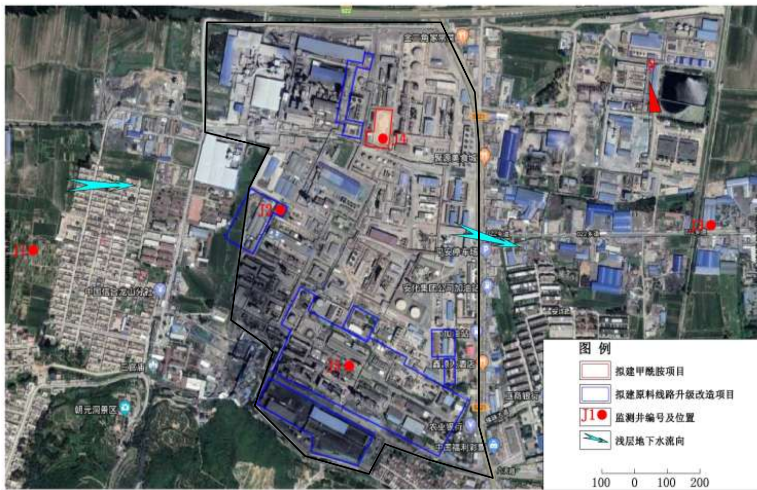
图 6.3-6 地下水水质监测井布置图
