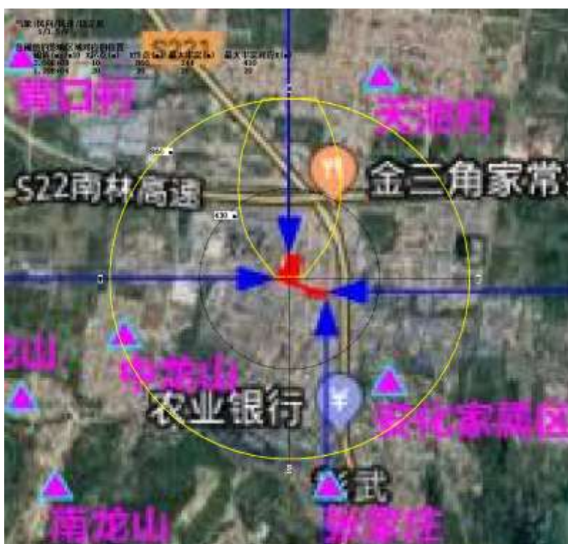
图 7.7-5 最不利气象条件下甲酸甲酯超过阈值最大轮廓线范围图
