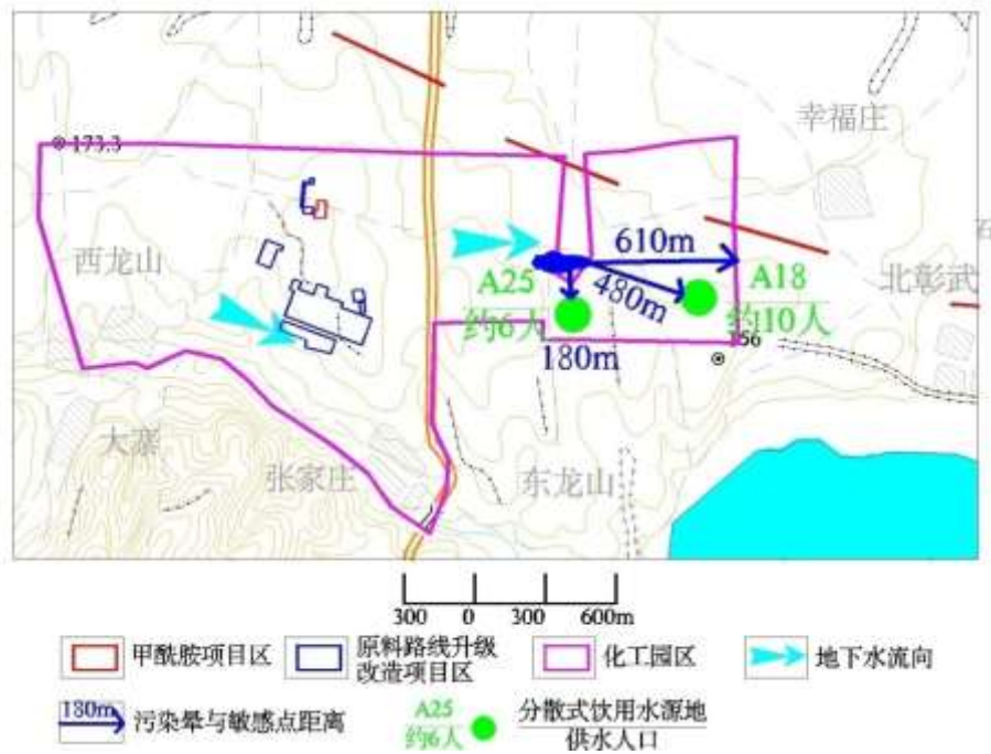
图 5.3-30 污水处理站生产废水调节池泄漏污染物 COD Mn 30 年最大运移距离与园区边界、敏感点等位置图
