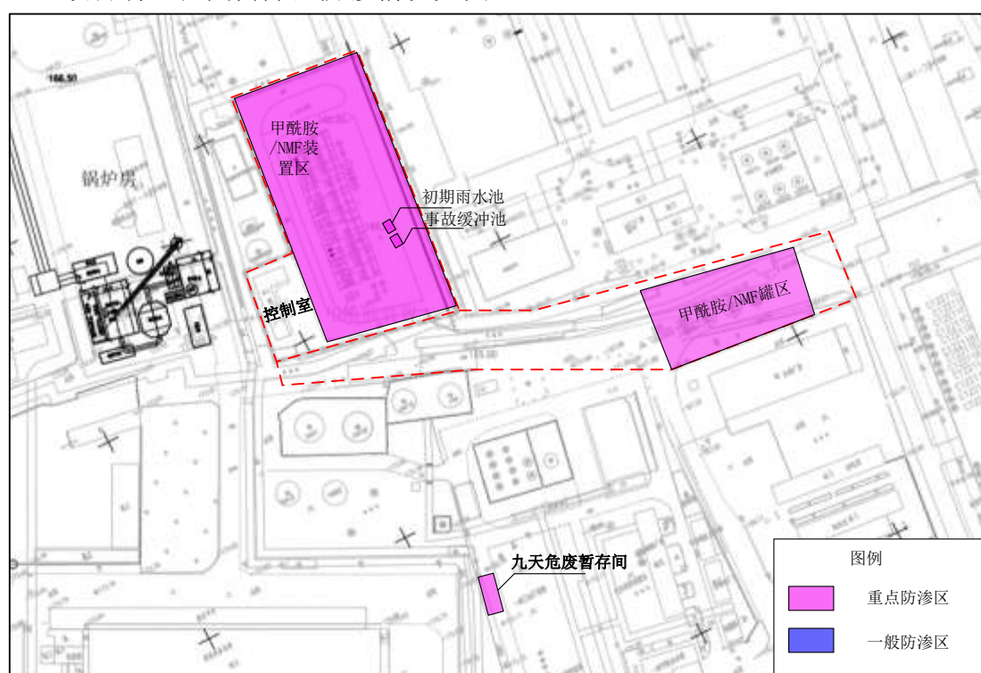
图 6.3-5 项目区地下水污染防治分区示意图
